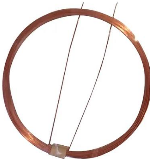
ABBILDUNG 4-8: BEISPIEL INDUSTRIELL GEFERTIGTE LUFTSPULE
