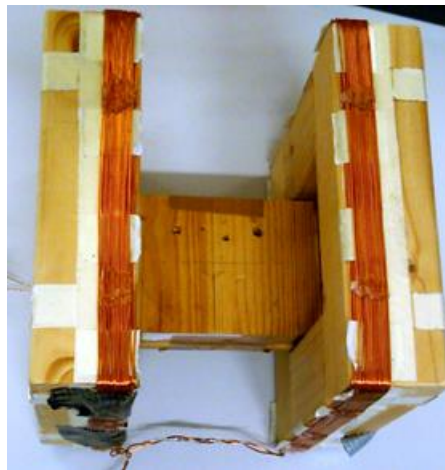
ABBILDUNG 4-5: LABORAUFBAU MIT HELMHOLTZSPULENPAAR
