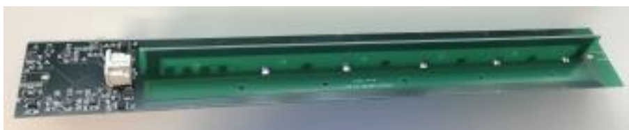
ABBILDUNG 4-7: BEISPIEL PCB-SPULE MIT ANSTEUERUNGSELEKTRONIK
