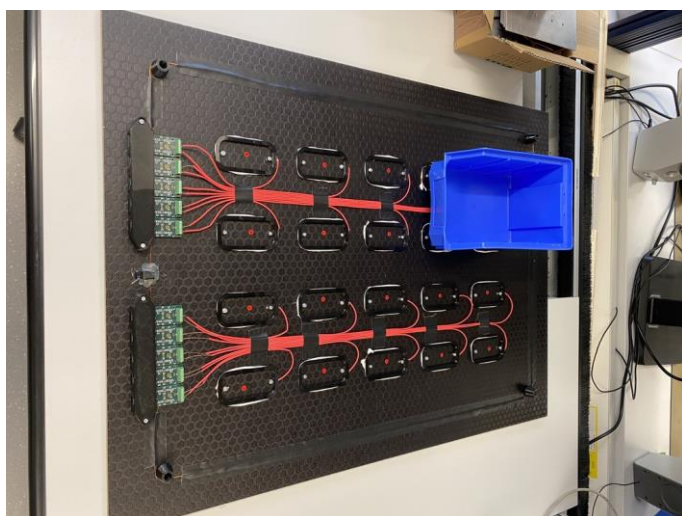
ABBILDUNG 4-17: ANTENNENARRAY ZUR ERFASSUNG UNTERSCHIEDLICHER BEHÄLTERGRÖßEN
